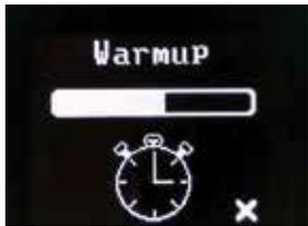
Una pantalla de calentamiento hará un conteo regresivo del tiempo hasta que el dispositivo esté listo para usted haga la prueba. Normalmente, el dispositivo estará listo en unos pocos segundos. En épocas de frío extremo, el dispositivo puede tardar hasta 3 minutos en calentar. Puede programar tres periodos de veinte minutos en 24 horas para que el dispositivo se encienda automáticamente y esté listo para una prueba cuando usted
