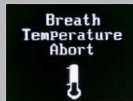
El aborto por temperatura del aliento ocurre cuando el aliento que se sopla en el dispositivo no es coherente con la temperatura normal del aliento humano. Eso se puede deber a que usted bebió una bebida con hielo o hizo ejercicio en un ambiente frío antes de una prueba. Si es así, espere unos minutos y pruebe de nuevo.
