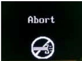
Si mientras intenta hacer una prueba recibe una pantalla con el mensaje Abort (Abortar), no significa que usted no pasó la prueba. Eso solo significa que el dispositivo no pudo analizar la muestra de su aliento. Hay varias cosas que pueden causar un aborto, como soplar con demasiada fuerza, soplar demasiado suavemente, no soplar durante suficiente tiempo o no tararear correctamente. El dispositivo le presentará la pantalla Abort (Abortar) indicando cuál fue el problema.
