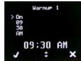
Para configurar los horarios de calentamiento, vaya a la pantalla Configuración y use el botón Arriba y Abajo para configurar cada horario.
