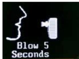
Para hacer una prueba correctamente tendrá que soplar en la boquilla durante el tiempo suficiente y con suficiente presión mientras genera un tono de tarareo diciendo la palabra "DU" al soplar. Cuando usted comience a soplar y tararear, el dispositivo emitirá un tono continuo que se detendrá cuando usted haya terminado la prueba.
