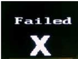
La pantalla Failed (Falló, o no pasó) significa que su muestra de aliento tiene un nivel de alcohol por encima del nivel predeterminado y que usted no podrá encender su vehículo. A la primera prueba que usted no pase la seguirá un período de bloqueo temporal obligatorio de 2 a 15 minutos (dependiendo de su jurisdicción).
