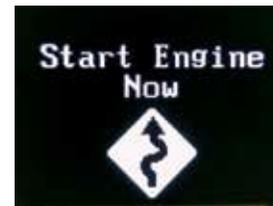
**Dependiendo de su jurisdicción, tendrá entre 60 segundos y 3 minutos para encender su vehículo.** Si no se enciende el motor en ese período de tiempo, su dispositivo entrará en modo "reposo" y usted tendrá que hacer otra prueba antes de poder encender su vehículo.
